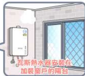
屋外式瓦斯熱水器 安裝在窗戶緊閉的陽台
